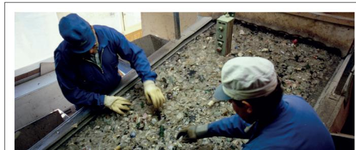
Arbeiter entfernen händisch Fremdkörper aus dem Altglas.
